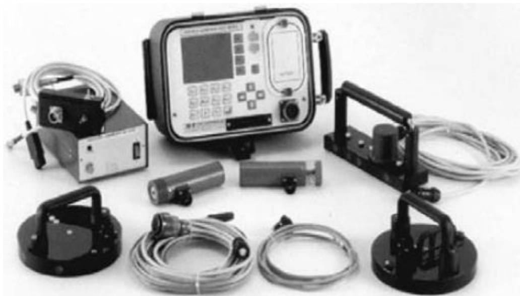
Διάγραμμα 3.9: Η συσκευή Gecor 8 της Geosica που χρησιμοποιεί προστατευτικούς δακτυλίους για περισσότερη ακρίβεια.
