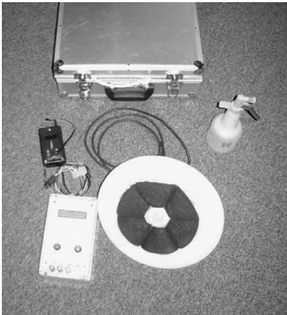
Διάγραμμα 3.8: Συσκευή μέτρησης του ρυθμού διάβρωσης που χρησιμοποιεί αγωγίμο επίθεμα αφρού ως βοηθητικό ηλεκτρόδιο
