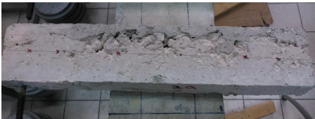
Διάγραμμα 4.4: Η δοκός 2b από την οποία απουσίαζαν μεγάλα τμήματα σκυροδέματος
