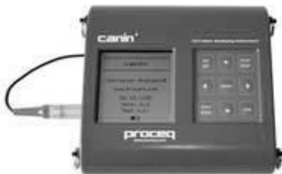
Διάγραμμα 3.3: Συσκευή μέτρησης του half cell potential της εταιρίας Proceq
