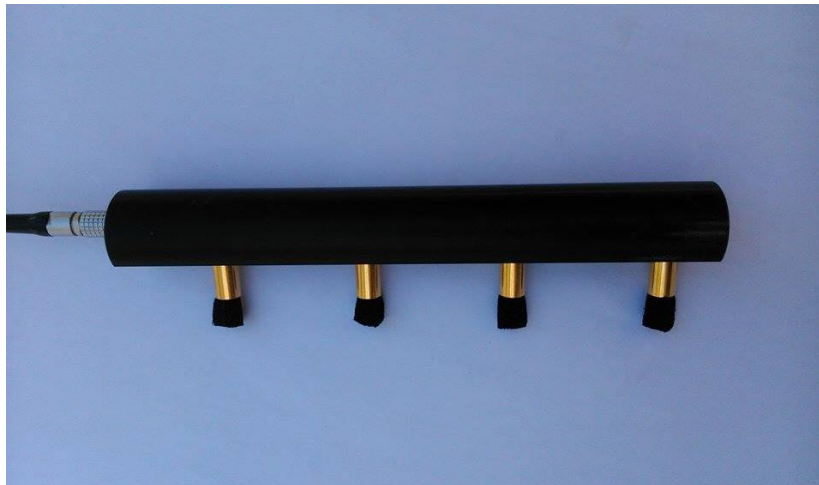
Διάγραμμα 3.4: Μετρητής αντίστασης τεσσάρων ηλεκτροδίων (Wenner probe) της εταιρίας Proceq
