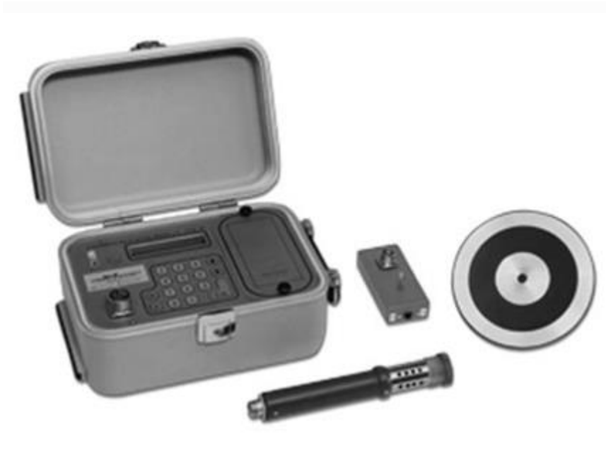
Διάγραμμα 3.6: Η συσκευή μέτρησης του ρυθμού διάβρωσης Gecor 6 με τον κυλινδρικό μετρητή αντίστασης της επικάλυψης του σκυροδέματος
