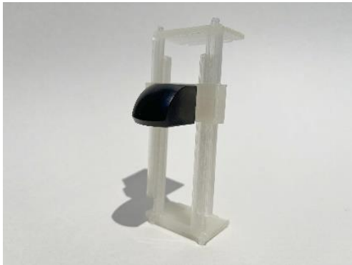
Εικόνα 13 Εκτυπωμένο πρωτότυπο με επικολλημένο καθρέπτη.
