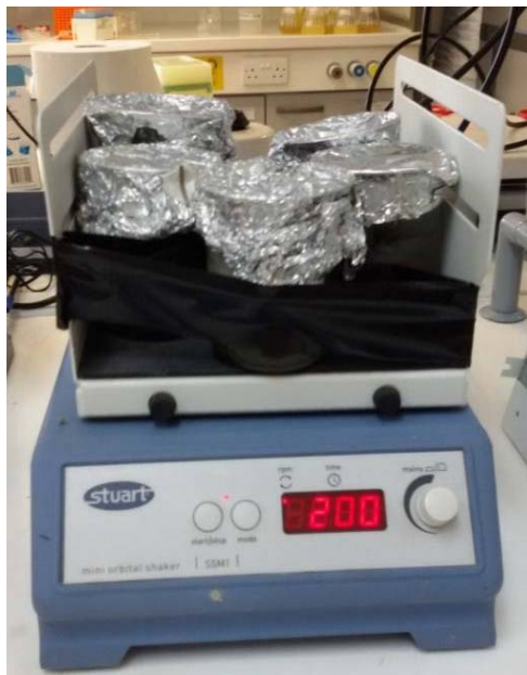
Εικόνα 8: Τα ποτήρια ζέσεως με τα μέρη του φυτού στη συσκευή ανακίνησης
