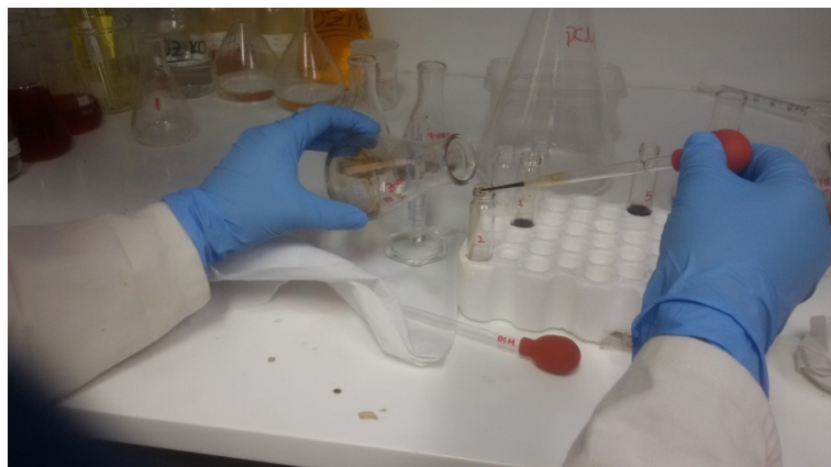
Εικόνα 13: Διάλυση του εξατμισμένου δείγματος σε διχλωρομεθάνιο και μεταφορά του σε φιαλίδιο 4ml
