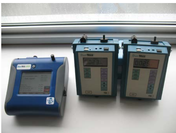
Εικόνα 11: Η συσκευή Dust Trak (model 8533) και Dust Trak (model 8520)
