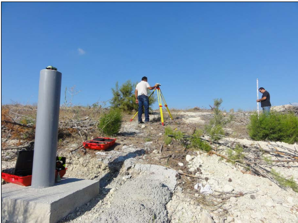
Εικόνα 15: Μέτρηση του ύψους της σκοπευτικής γραμμής του χωροβάτη
