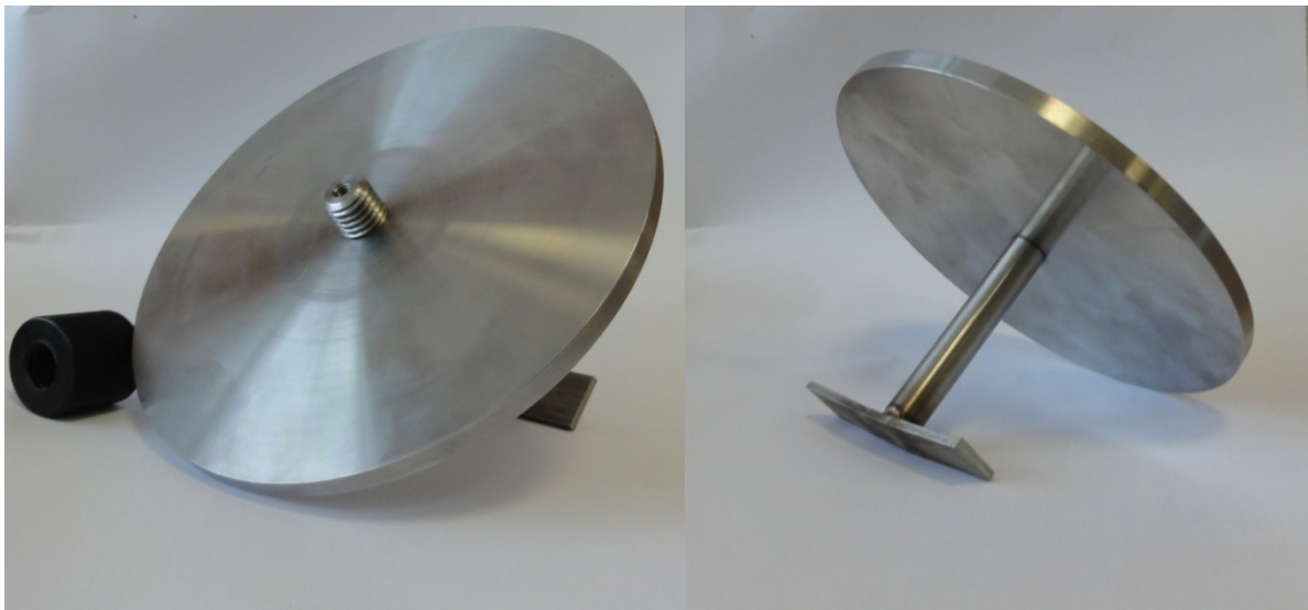
Εικόνα 7: Στρόγγυλη μεταλλική βάση μαζί με το προστατευτικό πώμα του κοιλία κέντρωσης.
