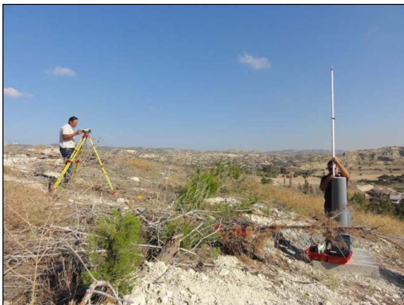
Εικόνα 16: Λήψη μέτρησης στην μεταλλική πλάκα(βάση τρικογλίου)
