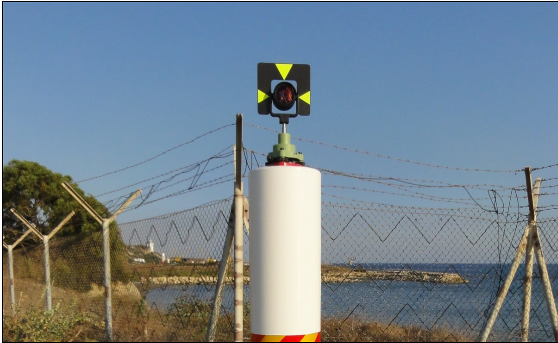
Εικόνα 17: Ανακλαστήρας έτοιμος για μέτρηση
