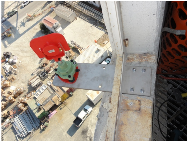
Εικόνα 5: Μεταλλική πλάκα που υλοποιεί σημείο του δικτύου
