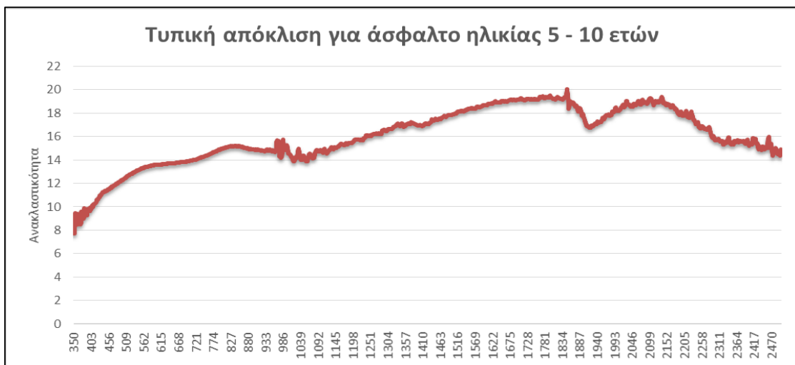
Διάγραμμα 3.22: Αντιπροσωπευτική φασματική υπογραφή για την τυπική απόκλιση του δείγματος ασφάλτου ηλικίας 5 – 10 ετών
