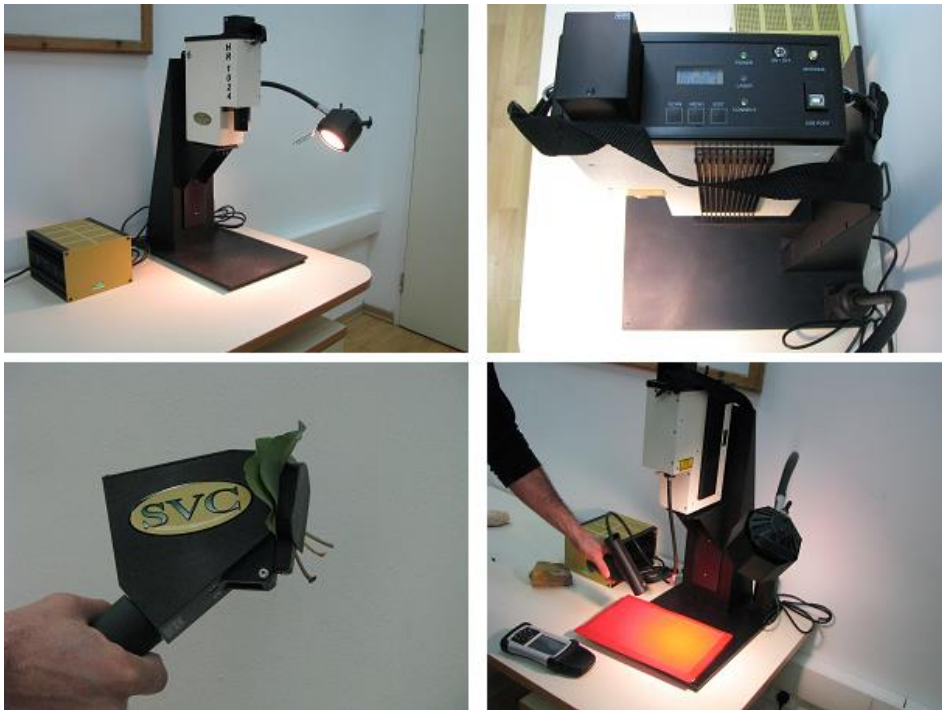
Εικόνα 2.3: Φασματοραδιόμετρο HR-1024 σε εργαστηριακή διάταξη (Πηγή: Levin 2000)
