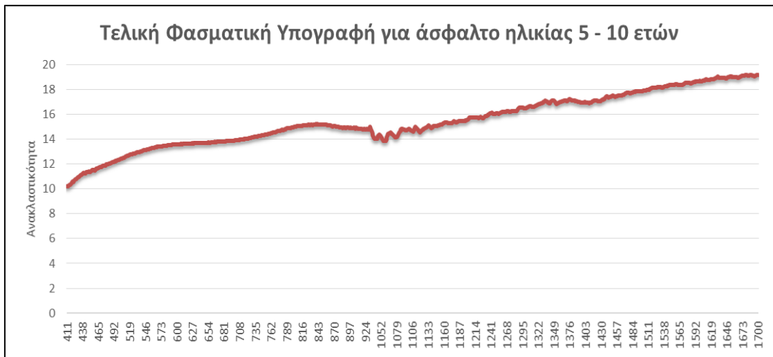
Διάγραμμα 3.26: Τελική αντιπροσωπευτική φασματική υπογραφή για την ανακλαστικότητα του δείγματος της ασφάλτου ηλικίας 5 – 10 ετών
