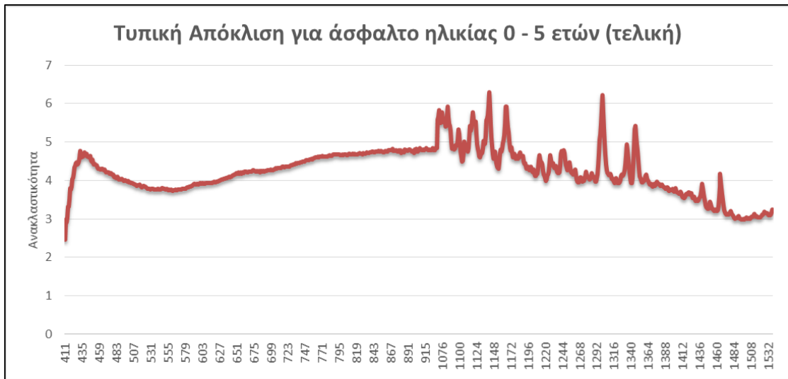
Διάγραμμα 3.33: Τελική αντιπροσωπευτική φασματική υπογραφή τυπικής απόκλισης ανακλαστικότητας του δείγματος της ασφάλτου ηλικίας 0 – 5 ετών
