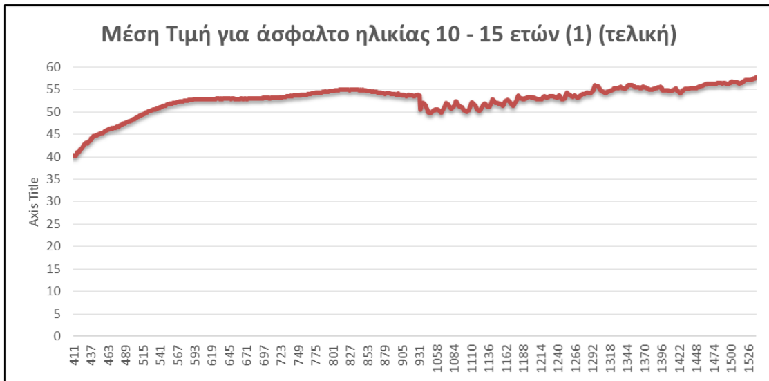
Διάγραμμα 3.31: Τελική αντιπροσωπευτική φασματική υπογραφή μέσης τιμής ανακλαστικότητας του πρώτου δείγματος της ασφάλτου ηλικίας 10 – 15 ετών
