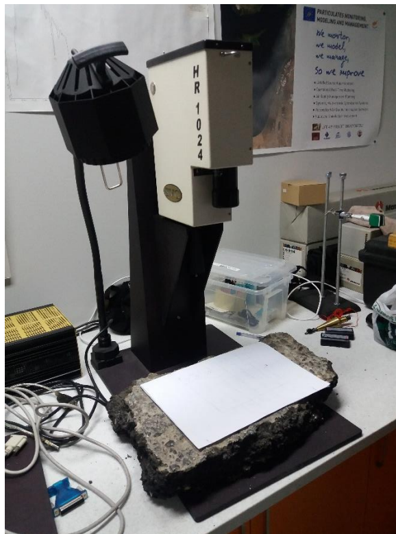
Εικόνα 2.4: Τελική Διάταξη φασματοραδιομέτρου, φωτιστικού και δείγματος ασφάλτου στο εργαστήριο τηλεπισκόπησης
