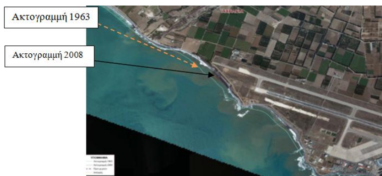
Εικόνα 1-5 Αχέλεια. Μέση διάβρωση κατά την περίοδο 1963-2008: 60 μέτρα
