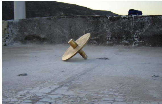
Εικόνα 13 Βάση στερέωσης τριχοχλίων από ορείχαλκο που χρησιμοποιήθηκε στο φράγμα του Κούρη
