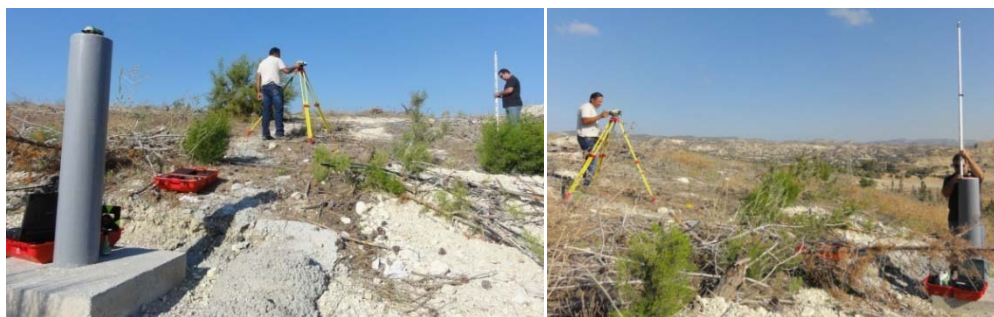
Εικόνα 18 Μέτρηση ύψους Οργάνου στο βάθρο
