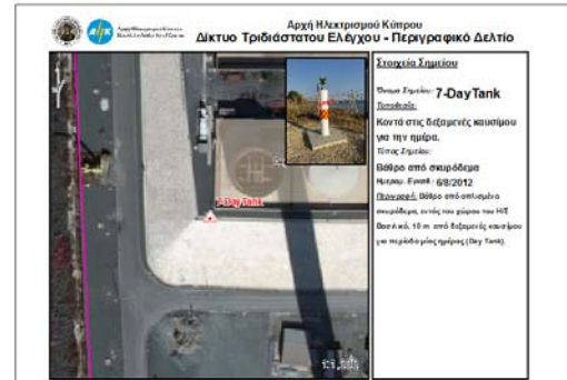
Εικόνα 6 Περιγραφικό Δελτίο για το σημείο 7-DayTank με στοιχεία εκτός συντεταγμένων και φωτογραφία βάθρου σε κλίμακα 1:1000
