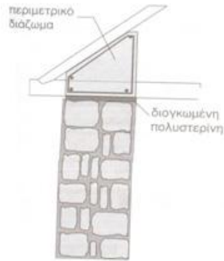
Εικόνα 165: Επαρκές κενό ανάμεσα σε τοίχο και στέγη
