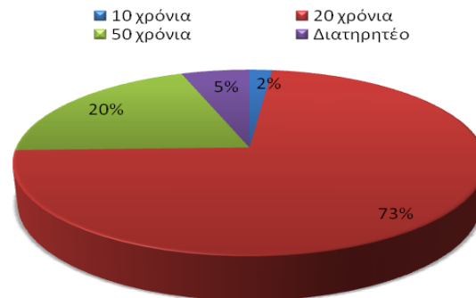
Εικόνα 21: Εναπομένουσα ζωή Σχολικών Κτιρίων αμέσως μετά την ενίσχυση
