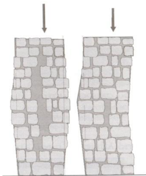
Εικόνα 148: Τοπική διόγκωση τοιχοποιίας
