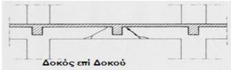
Εικόνα 109: Διατμητική αστοχία στη θέση έμμεσης στήριξης
