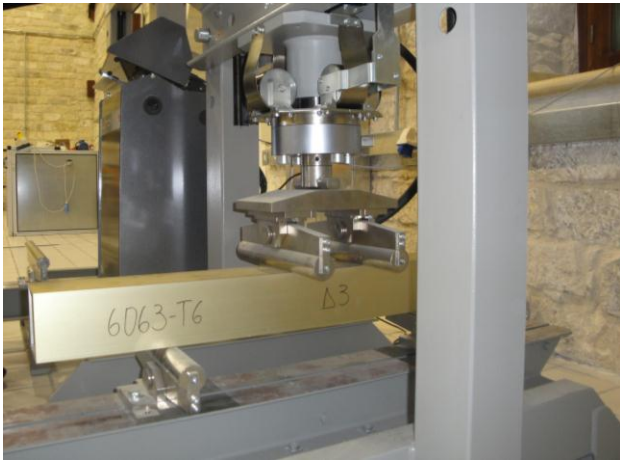
Εικόνα 25: Υποβολή του δοκιμίου Δ3 στο μοντέλο μηχανής κάμψης «CONTROLS 50-C1400/*-50-C1401/*»
