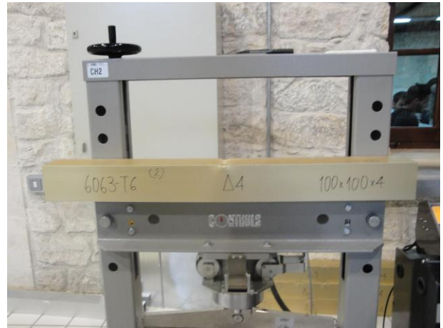
Εικόνα 26: Επιβολή ενός φορτίου κεντρικά του δοκιμίου Δ4
