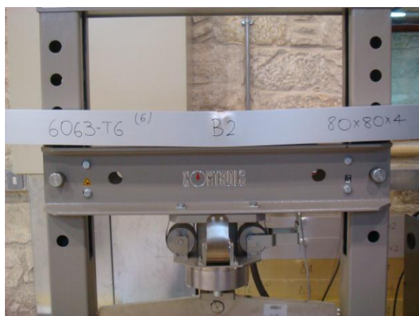
Εικόνα 48: Παραμόρφωση δοκιμίου B2, 80x80x4
