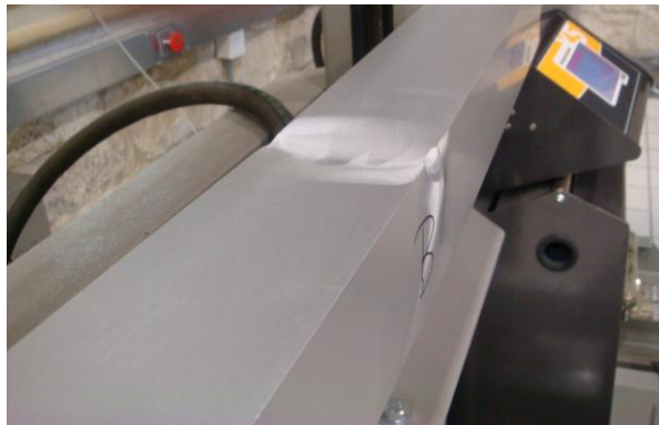
Εικόνα 46: Παραμόρφωση δοκιμίου B1, 80x80x4
