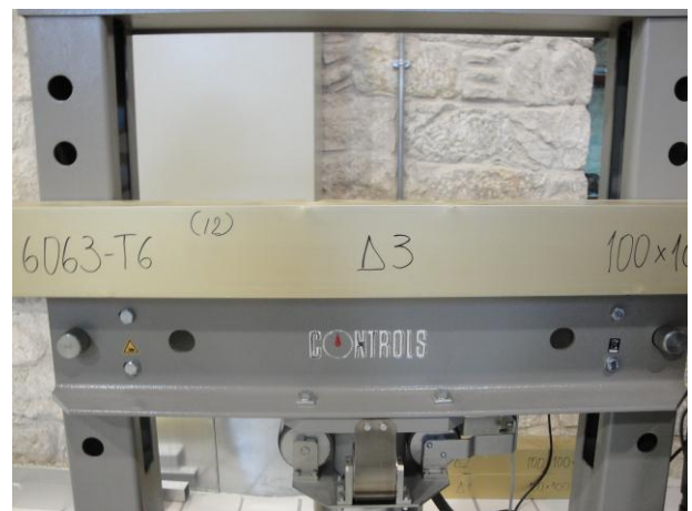
Εικόνα 29: Επιβολή δυο φορτίων έκκεντρα του δοκιμίου Δ3
