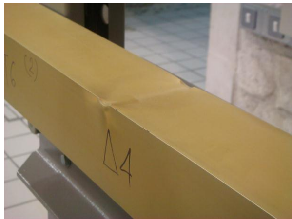
Εικόνα 41: Παραμόρφωση δοκιμίου Δ4, 100x100x4, υπό την επιβολή ενός φορτίου
