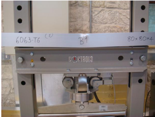
Εικόνα 44: Παραμόρφωση δοκιμίου B1, 80x80x4, υπό την επιβολή ενός φορτίου
