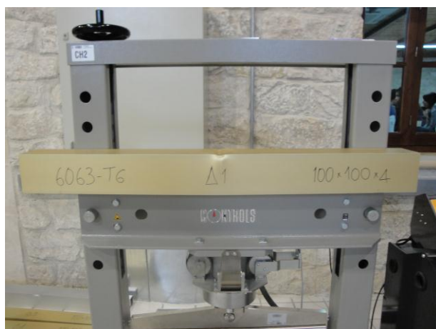
Εικόνα 19: Παραμόρφωση δοκιμίου Δ1 για επιβολή ενός φορτίου
