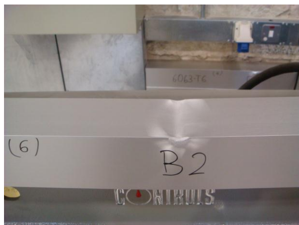
Εικόνα 49: Παραμόρφωση δοκιμίου B2, 80x80x4
