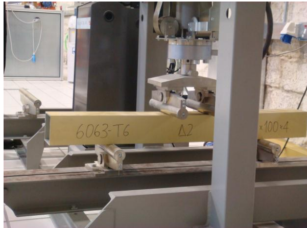
Εικόνα 39: Υποβολή δοκιμίου 100x100x4, σε διπλή φόρτιση, στη μηχανή «CONTROLS, 50-C1400/*-50-C1401/*»
