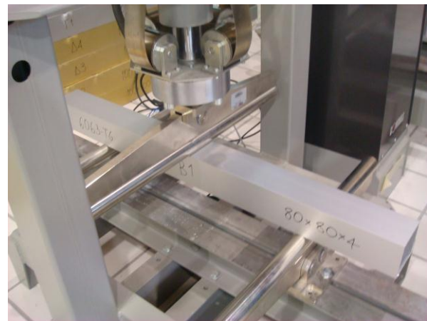
Εικόνα 43: Υποβολή δοκιμίου B1, 80x80x4, σε μια φόρτιση, στη μηχανή «CONTROLS, 50-C1400/*-50-C1401/*»
