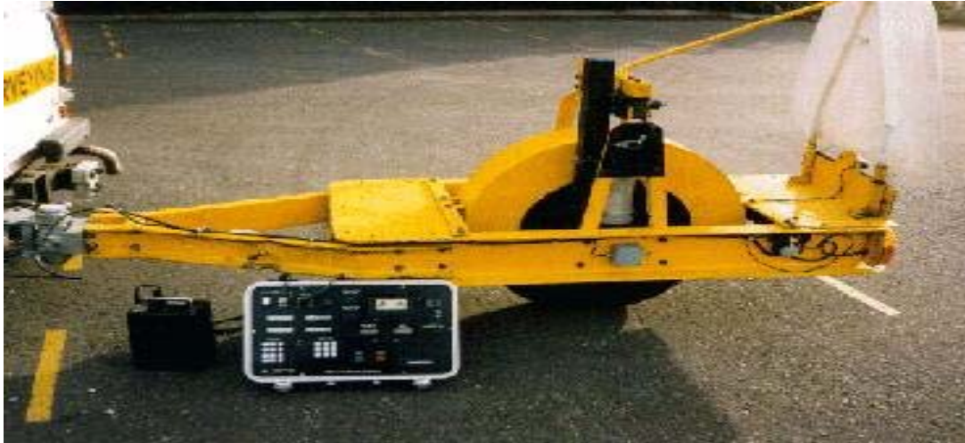
Εικόνα 4. Μέτρηση Ομαλότητας με ηλεκτρονικά μέσα
