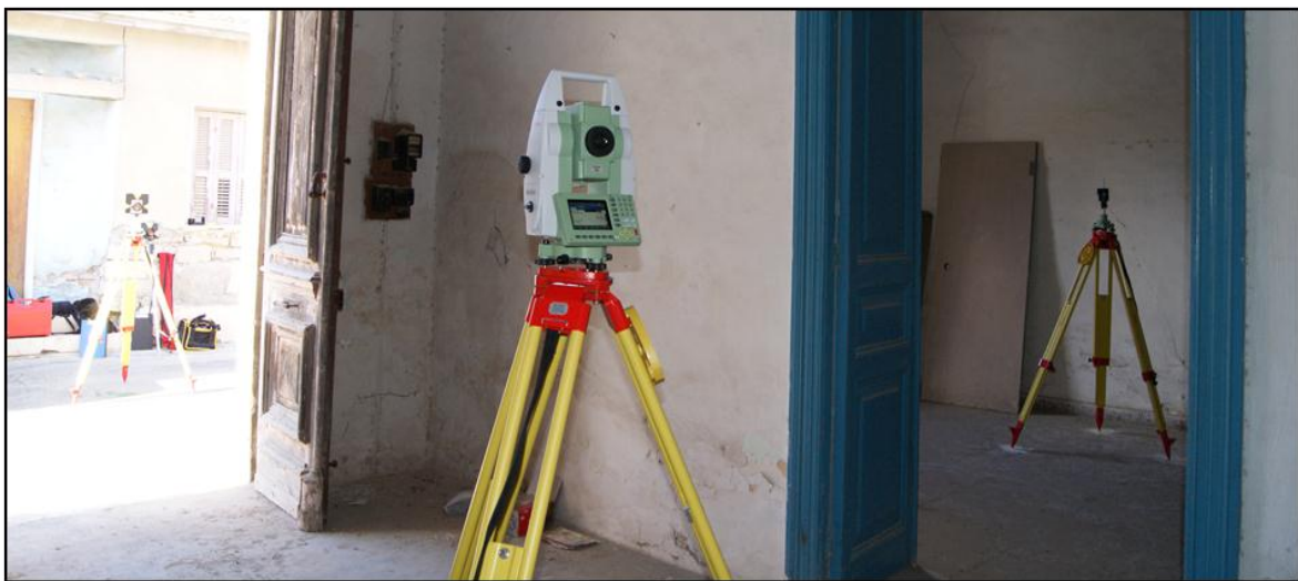
Εικόνα 24 Τοποθέτηση γεωδαιτικού σταθμού στο δωμάτιο 101 με μέγιστη δυνατή ορατότητα από τις υπόλοιπες στάσεις και σημεία ενδιαφέροντος.
