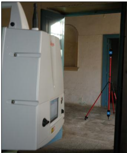
Εικόνα 31. Σκόπευση από το laser scanner στο twin reflector.
