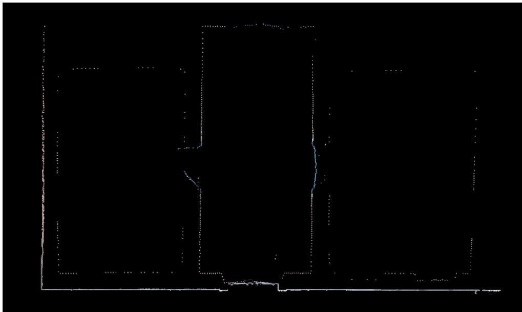
Εικόνα 47. Τομή νέφος σημείων με πάχος 0.06m.
