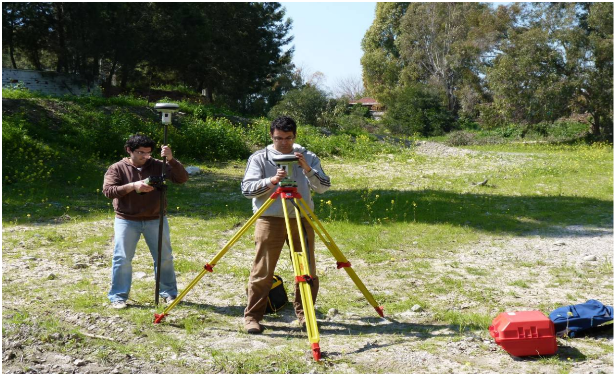
Εικόνα 8-5: Τοποθέτηση πομπού για να γίνει αποτύπωση με Leica Gps
