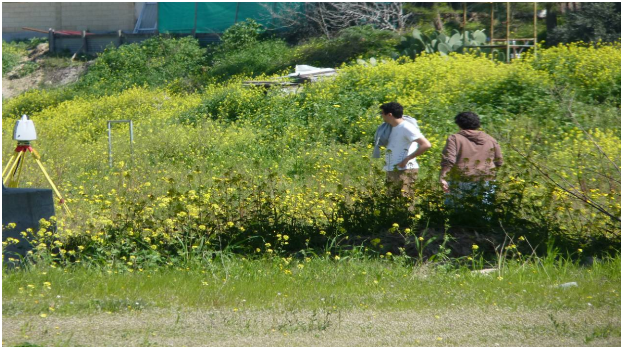
Εικόνα 8-4: Τοποθέτηση στόχων αποτύπωση περιοχής με Laser Scanner Leica
