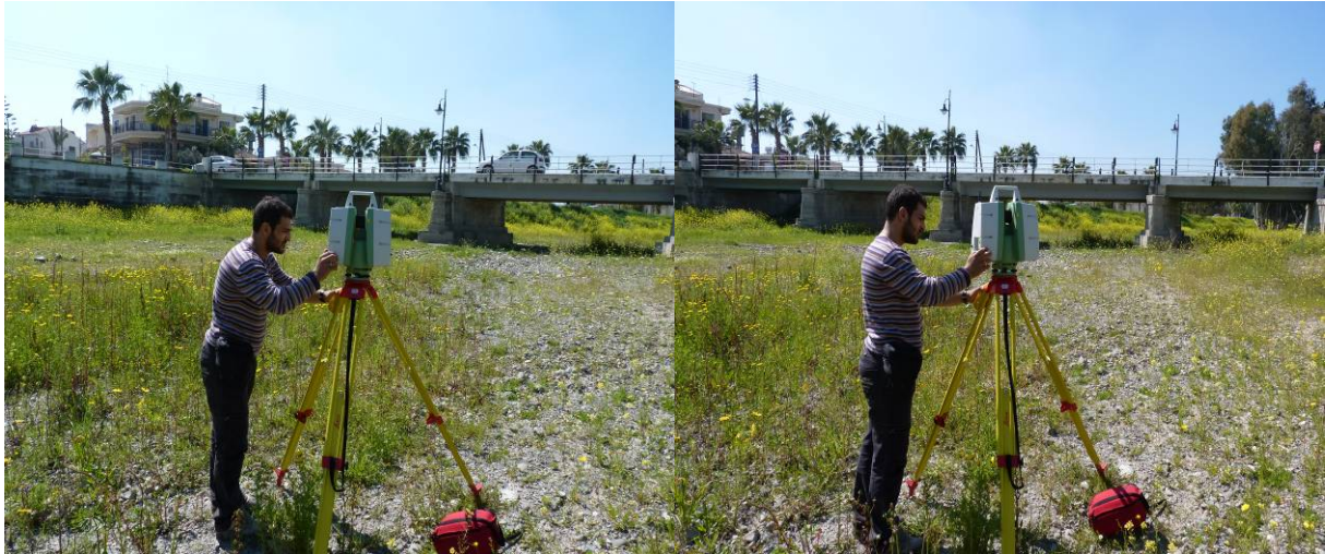
Εικόνα 8-1: Τοποθέτηση και οριζοντίωση τρισδιάστατου σαρωτή, Leica Laser Scanner
