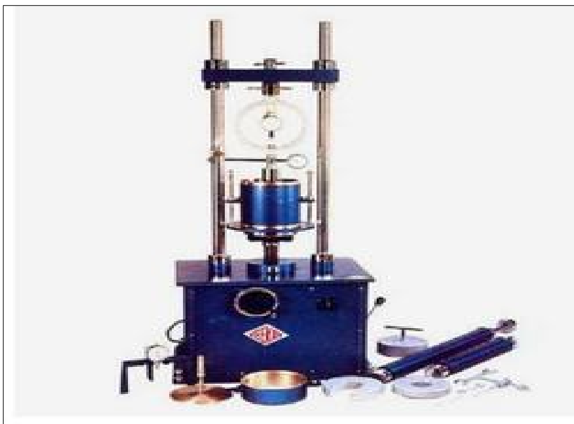
Εικόνα 2. 1: Συσκευή διεξαγωγής εργαστηριακού ελέγχου CBR.
