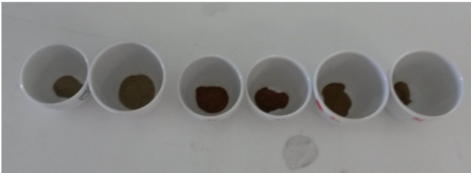
Εικόνα 3: Κάψες πριν τοποθετηθούν στο φούρνο
