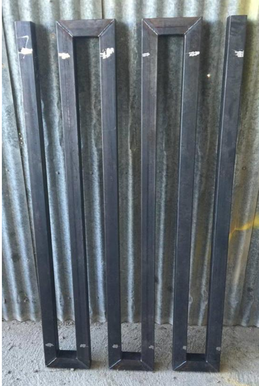
Σχήμα 4- 26: Κατασκευή αγωγού με πασαμάνια
