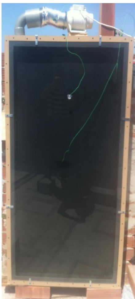
Σχήμα 4- 4: Συλλέκτης με εσωτερικά διαχωριστικά τοιχώματα μετάλλου (τύπου II)
