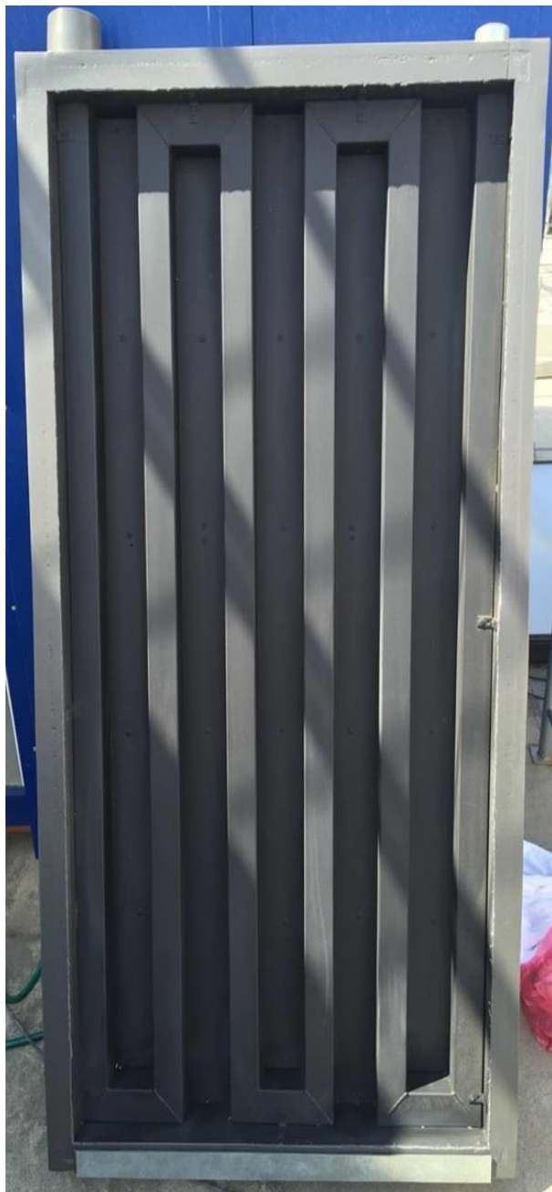
Σχήμα 4- 28: Μπογιατίσις με αστάρι και μαύρη Mad μπογιά της απορροφητικής πλάκας και του αγωγού
