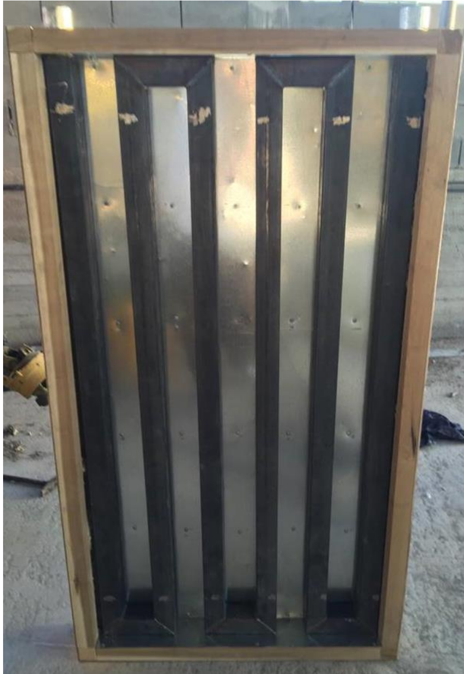
Σχήμα 4- 27: Τοποθέτηση της απορροφητικής πλάκας και του αγωγού στο συλλέκτη
