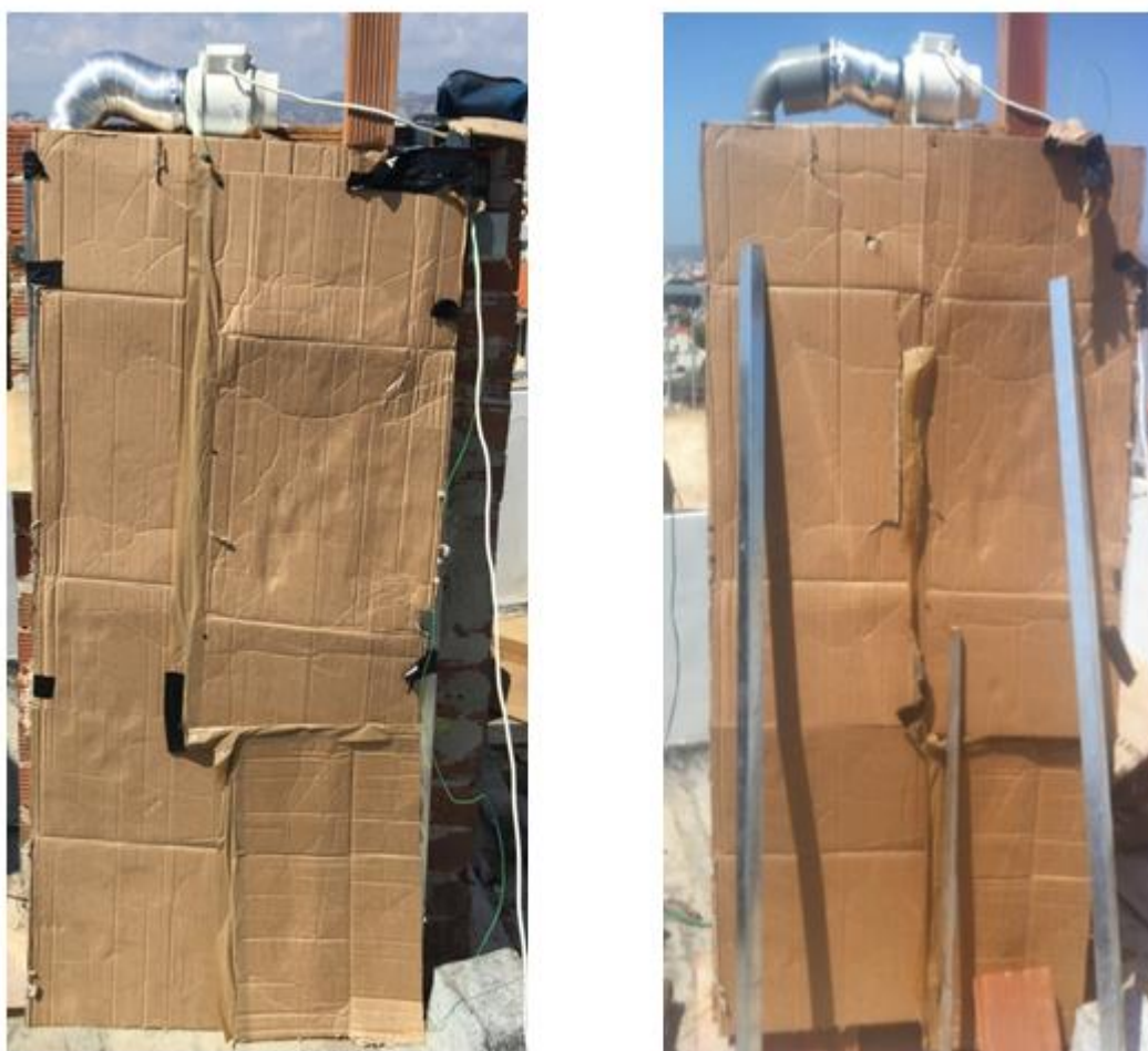
Σχήμα 5- 14: Σκίαση των συλλεκτών με χαρτόνι
