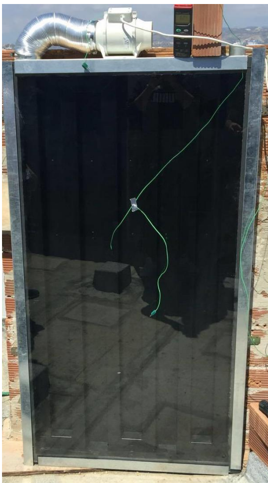
Σχήμα 4- 3: Συλλέκτης με τετράγωνους αγωγούς μετάλλου (πασαμάννα)
