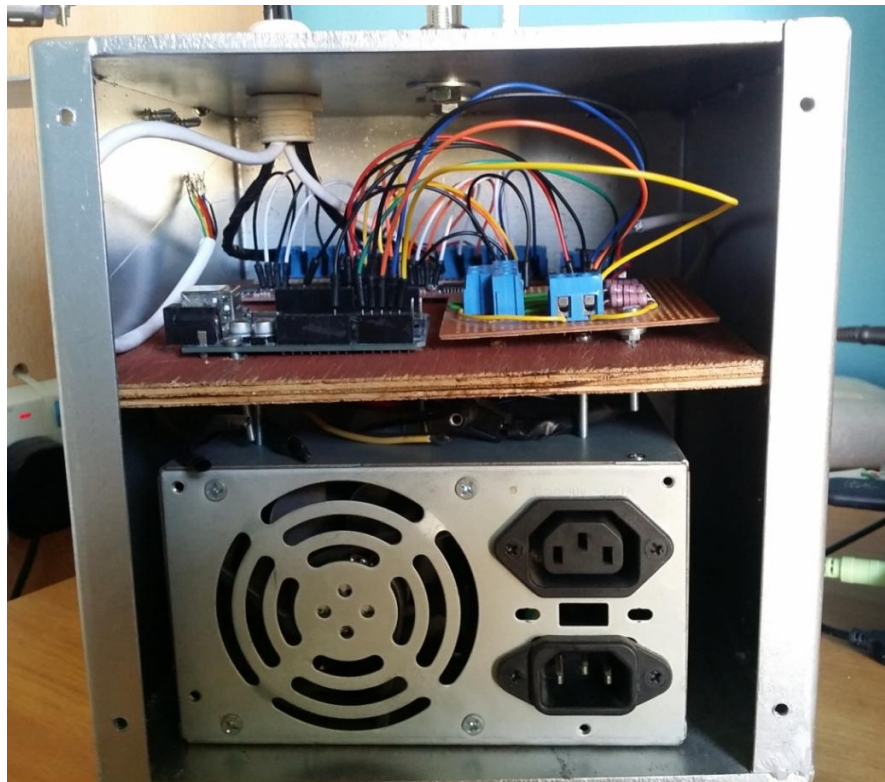
Εικόνα 5.1δ: Τροφοδοτικό και πλακέτα ηλεκτρονικών στο κουτί του μοντέλου
