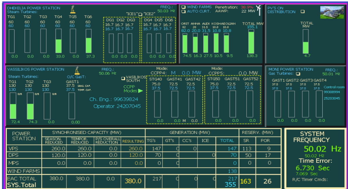
Εικόνα 7.4δ: 22 Μαρτίου 2015 – SCADA control screen
