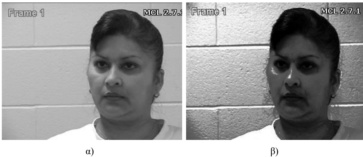
Διάγρ. 3.3: Εφαρμογή ισοστάθμισης ιστογράμματος σε α) αρχικό πλαίσιο από βίντεο, β) ισοσταθμισμένο πλαίσιο με την μέθοδο ισοστάθμισης ιστογράμματος.
