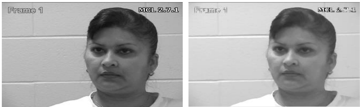
Διάγρ. 3.6: Κανονικοποίηση ιστογράμματος και εφαρμογή μέσου φίλτρου, σε α) αρχικό πλαίσιο από βίντεο, β) κανονικοποιημένο και φιλτραρισμένο πλαίσιο με την μέθοδο κανονικοποίησης και εφαρμογής μέσου φίλτρου.
