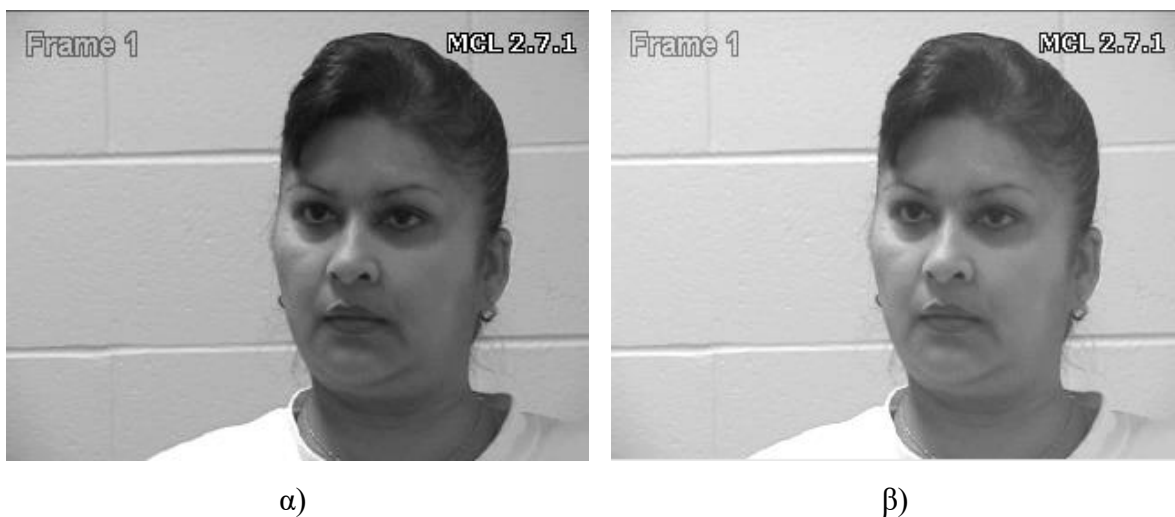
Διάγρ. 3.4: Εφαρμογή κανονικοποίησης ιστογράμματος σε α) αρχικό πλαίσιο από βίντεο, β) κανονικοποιημένο πλαίσιο με την μέθοδο κανονικοποίησης ιστογράμματος.
