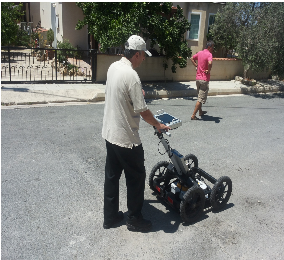
Εικόνα 5-7: Περιοχή Σάρωσης με Γεωραντάρ
