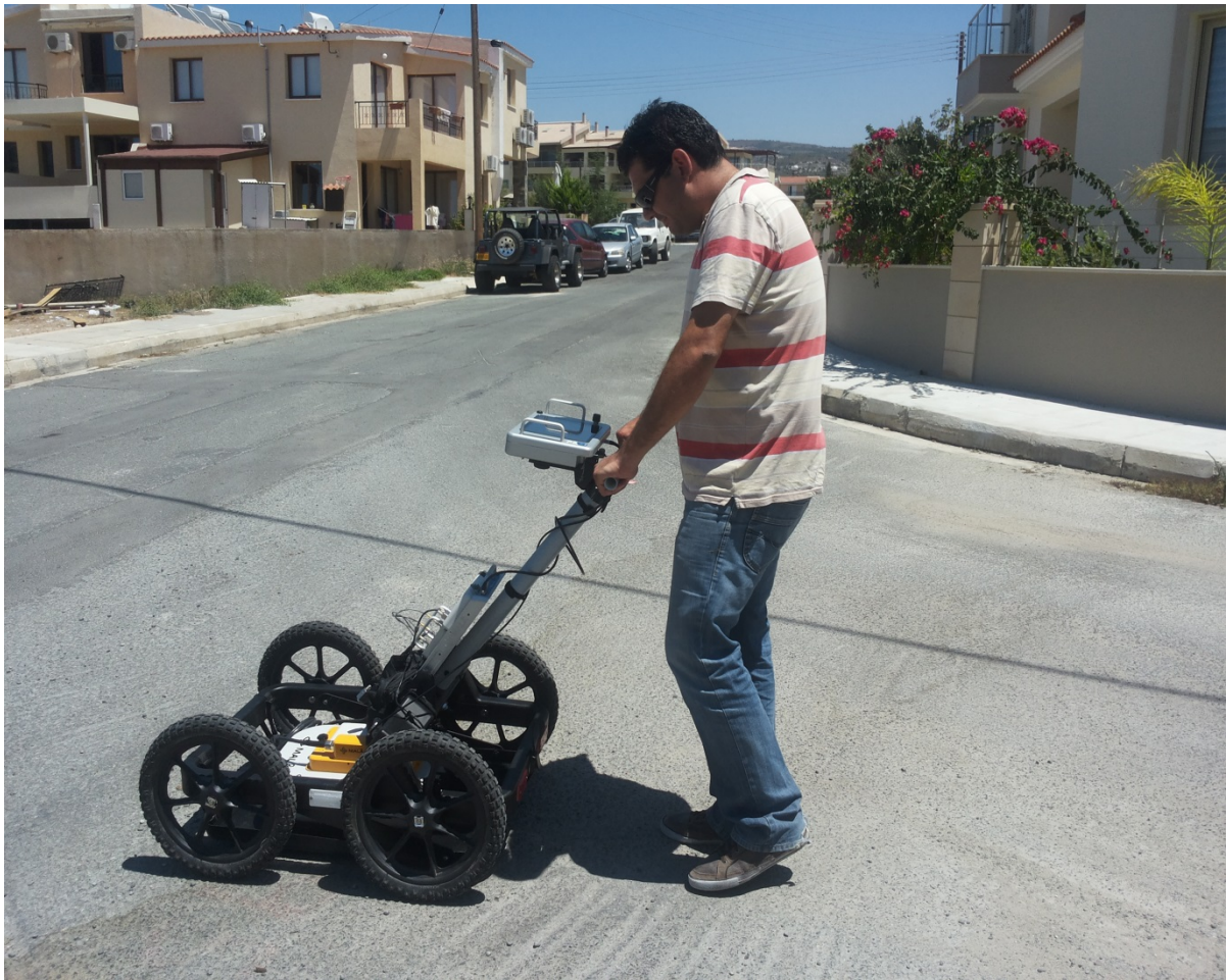
Εικόνα 5-4: Γεωραντάρ MALA που χρησιμοποιήθηκε για την σάρωση των υπόγειων αγωγών
