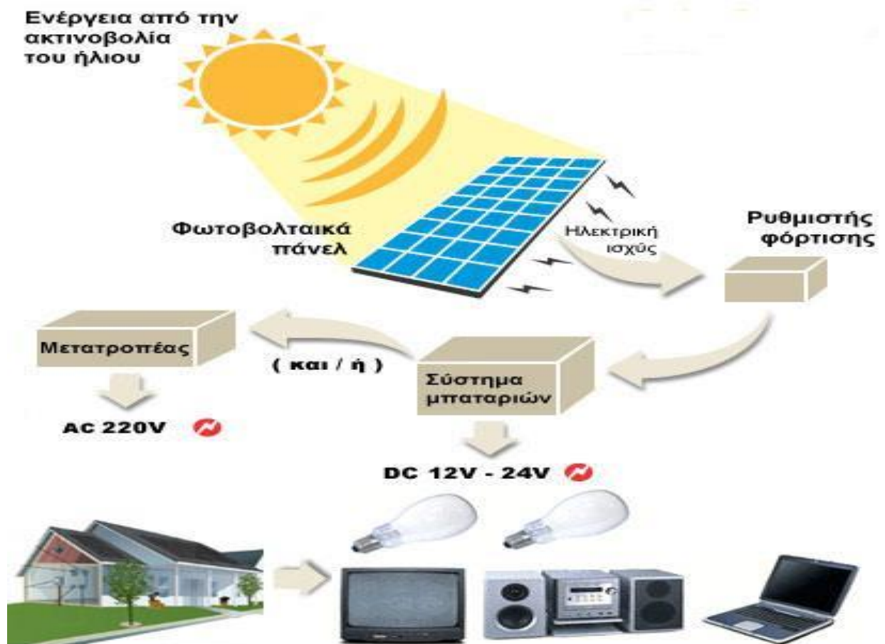
Διάγραμμα 9.1: Αυτόνομο Φωτοβολταϊκό Σύστημα
