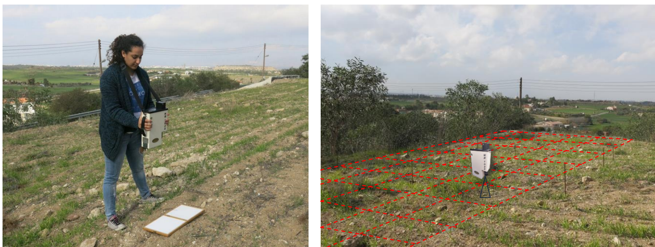
Εικόνα 8: Μετρήσεις με επίγειο φασματοραδιόμετρο στο ελεγχόμενο πεδίο σε κριθάρι.
