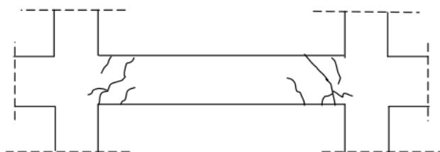
Σχήμα 2.7: Διατμητική αστοχία δοκού.
