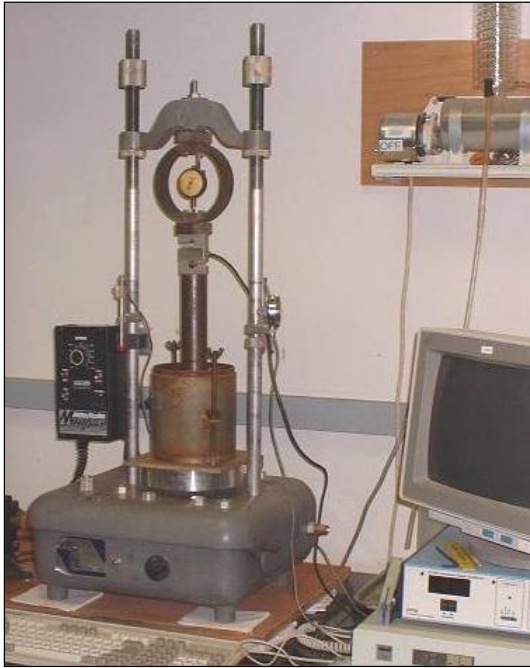
Σχήμα 2-1: (α) Συσκευή διεξαγωγή εργαστηριακού ελέγχου CBR και (β) συσκευή πεδίου για έλεγχο CBR Πηγή: Σακελλαρίου κ.ά., 2003
