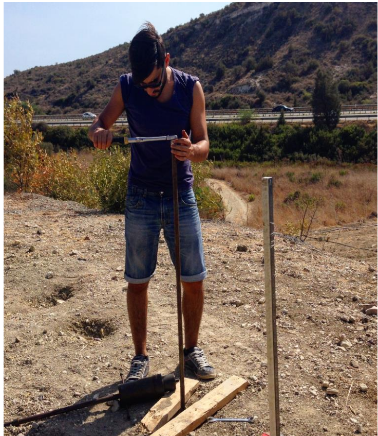
Εικόνα 13 Μέτρηση ροπής με το δυναμόκλειδο
