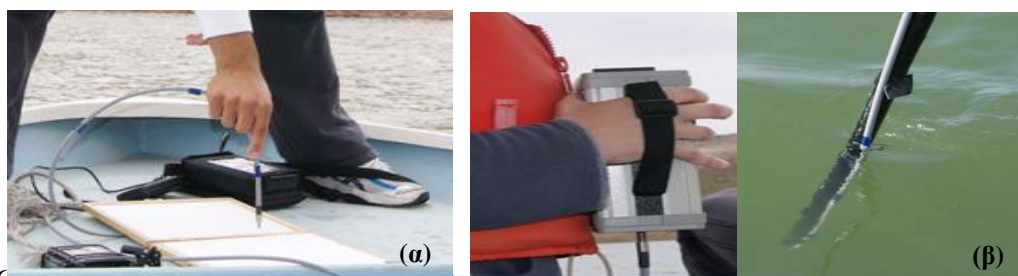
Εικόνα 61: Μετρήσεις στο φράγμα του Ασπρόγκρεμμου. Μετρηση στο φακωτικό στόχο (α) και βύθιση της οπτικής ίνας στο φράγμα (β)
