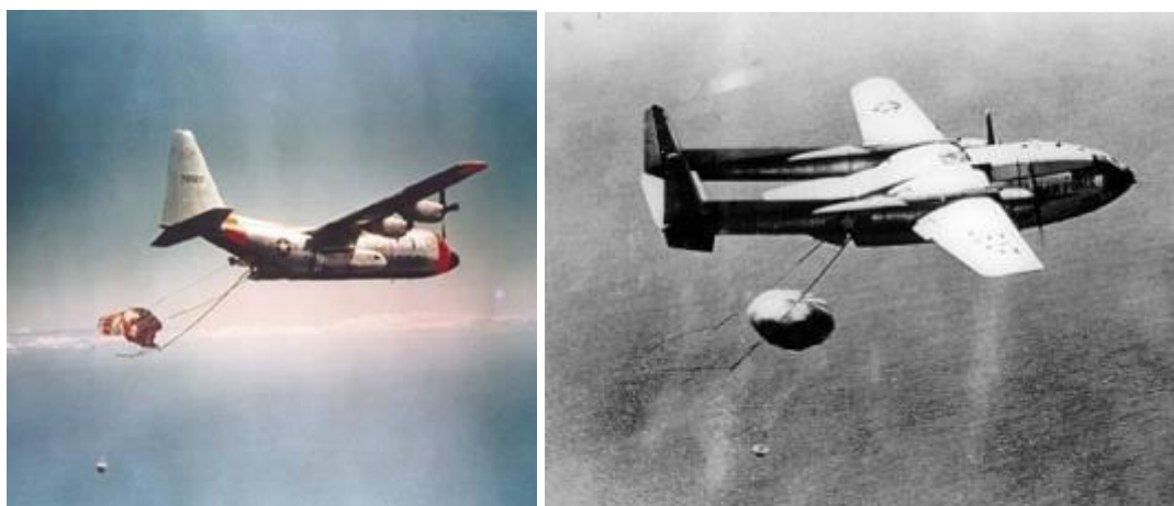
Εικόνα 57: Αεροσκάφη ανακτούν την κυψέλη που περιέχει το φωτογραφικό φιλμ από το δορυφόρο CORONA.
