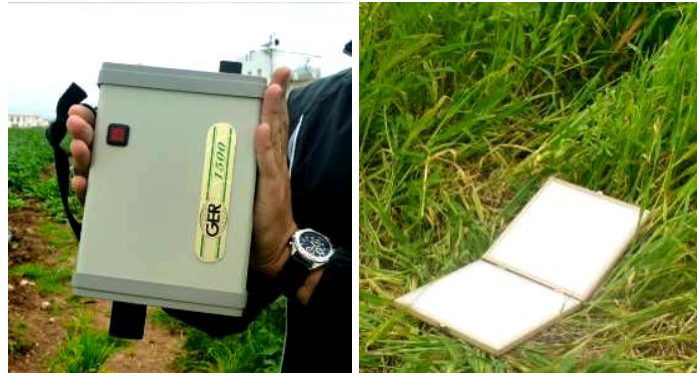
Εικόνα 20: Το φασματοραδιόμετρο GER 1500 που χρησιμοποιήθηκε στη διατριβή (αριστερά), το spectralone panel (δεξιά)
