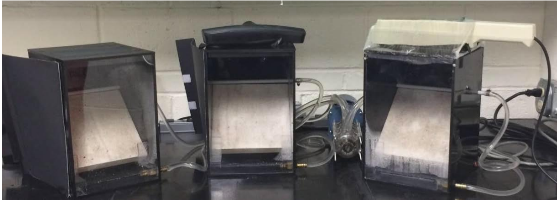
Σχήμα 59. Πειράματα εξομοίωσης καιρικών συνθηκών που έγιναν με δείγματα σκυροδέματος TX Active. Από αριστερά σε δεξιά: απουσίας φωτός, έκθεση υπό ορατό φως, έκθεση υπό υπεριώδες φως [30].
