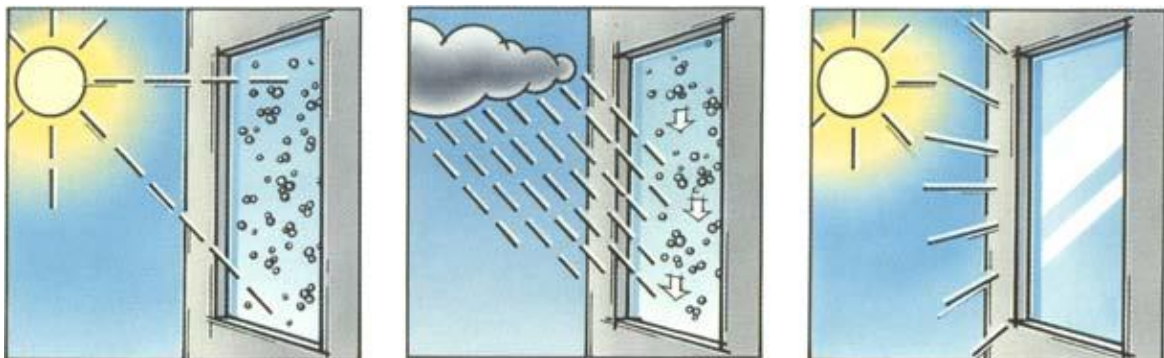
Σχήμα 47. Η υδροφοβική επιφάνεια ξεπλένεται από το νερό και έτσι μπορεί εύκολα να σκουπιστεί [1].
