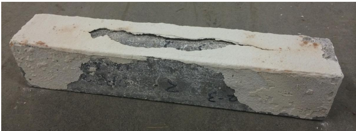
Σχήμα 61. Το επιχρίσμα i.active-COAT στο δείγμα σκυροδέματος OPC μετά τη δοκιμή κατάψυξης-απόψυξης. Προσέξτε τη δημιουργία ρωγμών, την αποκόλληση, και το θρυμματισμό του επιχρίσματος [30].
