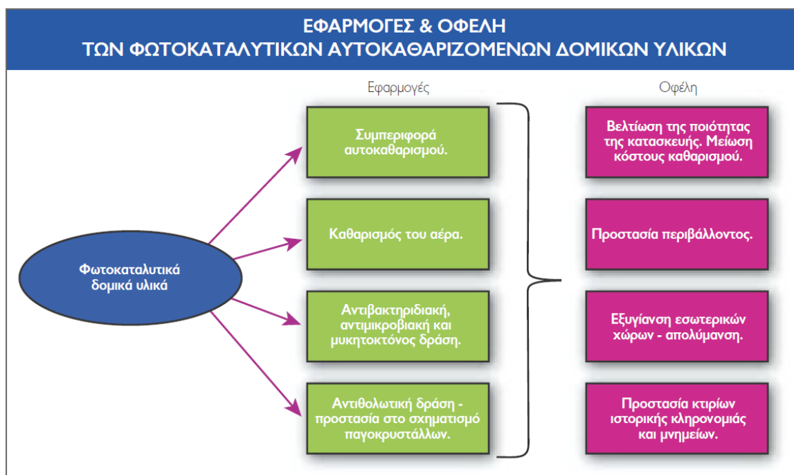
Σχήμα 26. Εφαρμογές και οφέλη των φωτοκαταλυτικών αυτοκαθαριζόμενων δομικών υλικών [4].
