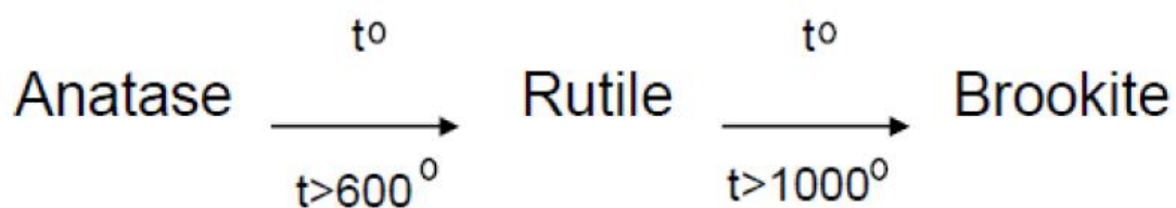
Σχήμα 22. Η μετατροπή του \text{TiO}_2 κάτω από υψηλές θερμοκρασίες [29].
