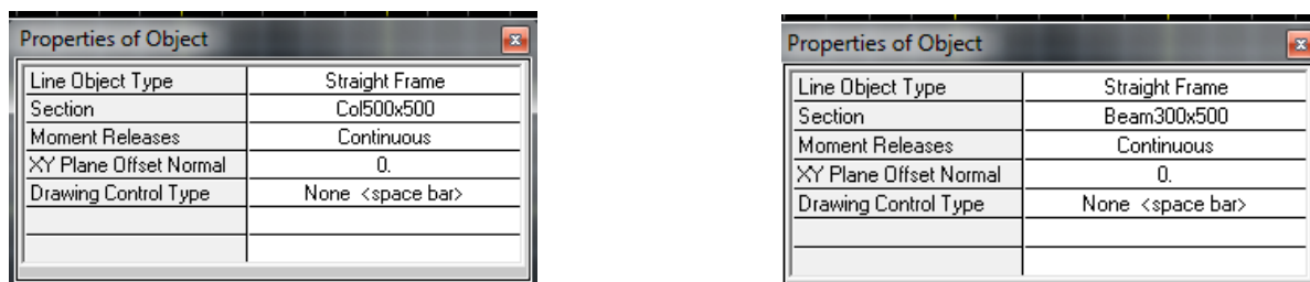
Σχήμα 11: Καθορισμός των διατομών κατά την διάρκεια σχεδιασμού του φορέα
