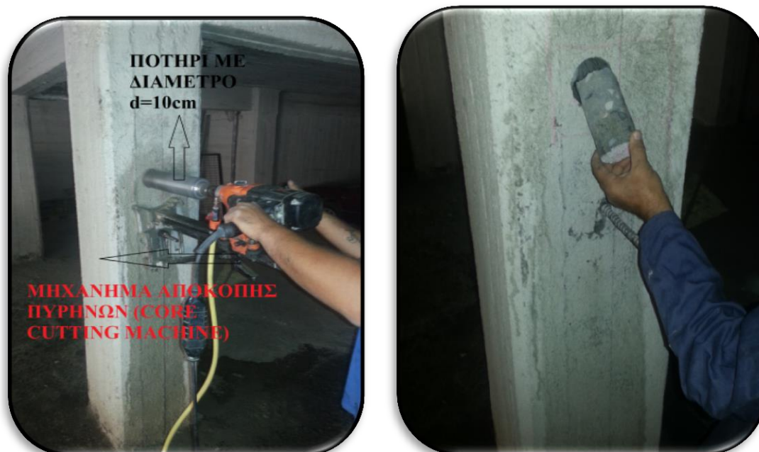
Σχήμα 4: Μηχάνημα αποκοπής πυρήνων – Πυρήνας (Πηγή: Μάθημα Ερευνητικές Μέθοδοι, Το φαινόμενο ενανθράκωση και η επιπτώσεις του στους οπλισμούς, Χρίστου Γιώργος, ΤΕΠΑΚ 2013)
