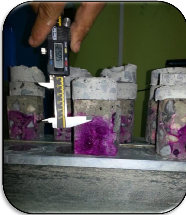
Σχήμα 7: Μέτρηση βάθους ενανθρακωμένου σκυροδέματος – Επίδραση φαινολοφθαλεΐνης (Πηγή: Μάθημα Ερευνητικές Μέθοδοι, Το φαινόμενο ενανθράκωση και η επιπτώσεις του στους οπλισμούς, Χρίστου Γιώργος, ΤΕΠΑΚ 2013)
