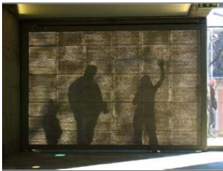
Διάγραμμα 10: Φύλλα 'LiTraCon' παραγόμενα από μείγμα σκυροδέματος με ανακυκλωμένο γυαλί.
