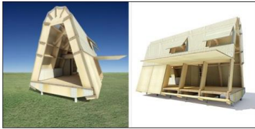
Διάγραμμα 29: Το προκατασκευασμένο κτίριο «Cardboard House» από χαρτόνι.
