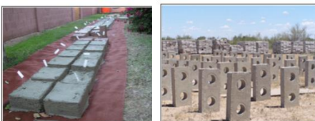
Διάγραμμα 27: Δομικά Στοιχεία από 'Papercrete' κατά την ξήρανση (αριστερά) και με διαμόρφωση οπής κοιλοδοκού (δεξιά).
