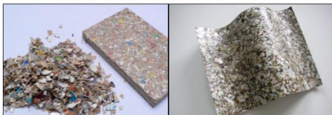
Διάγραμμα 36: Πλακίδια και Φύλλα μετά από θερμική συμπίεση του τύπου Tetrapak.
