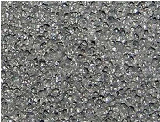
Διάγραμμα 8 : Αφρώδες γυαλί – Πλάκα δεξιά και αριστερά οι κυψελίδες.
