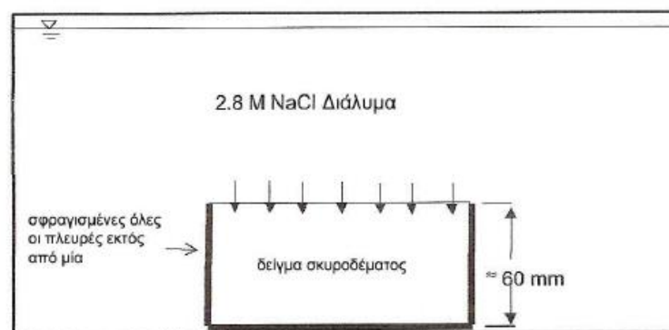
Σχήμα 28: Σχηματική απεικόνιση δοκιμής NT Build 443 (Τεταγιώτη, 2011).
