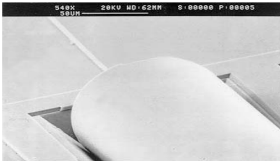
Εικόνα 3.17 Οπτική ίνα σε μια V - αυλάκωση
