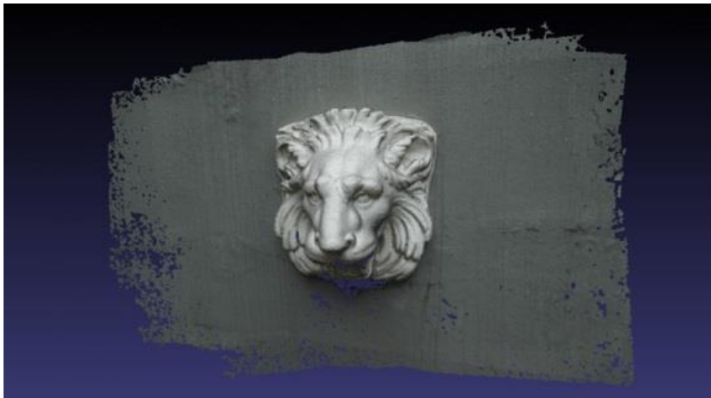
Εικόνα 31: Αποτέλεσμα της χρήσης της φωτογραμμετρίας για την ακριβής ψηφιοποίηση αρχαιολογικών ευρημάτων.
