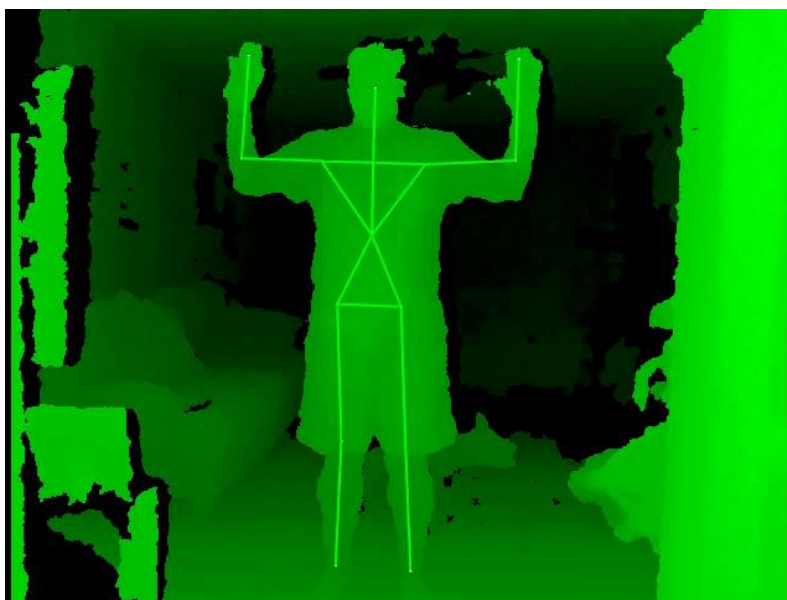
Εικόνα 1. Η αναπαράσταση του σκελετού που αναγνωρίζει το Kinect
