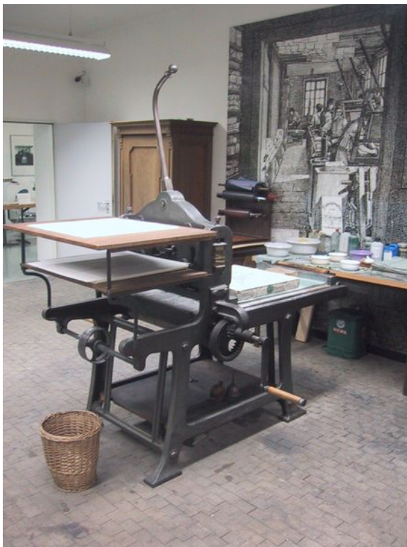
Εικόνα 49: Λιθογραφική τυπογραφική πρέσα Steinhandhebelpresse Krause 1934 στο Landesamt für Vermessung und Geoinformation
