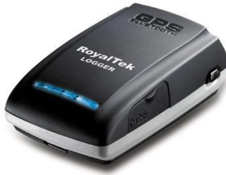
Εικόνα 1: Συσκευή καταγραφής GPS RoyalTek RBT-2300
