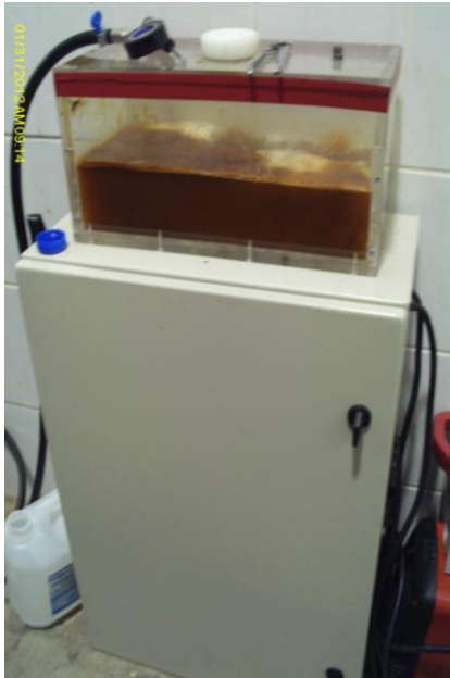
Εικόνα 3.4: Συσκευή ηλεκτρόλυσης η οποία κατασκευάστηκε και εγκαταστάθηκε με το δοχείο που περιέχει το αποσταγμένο νερό με τον ηλεκτρολύτη στο πάνω μέρος της.
