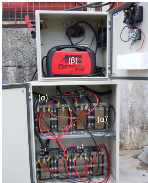
Εικόνα 3.5: Συσκευή ηλεκτρόλυσης που χρησιμοποιήθηκε για την παραγωγή H_2 . Όπου: α) κελιά ηλεκτρόλυσης με το νερό να διέρχεται μέσα από αυτά, β) μετατροπείας ηλεκτρικού ρεύματος και γ) δοχεία αποθήκευσης αποσταγμένου νερού που είναι τοποθετημένα στο πίσω μέρος της συσκευής.
