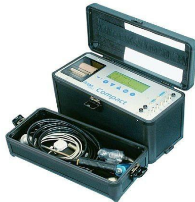
Εικόνα 3.7: Ο φορητός αναλυτής Dräger MSI Compact ο οποίος χρησιμοποιήθηκε για τη μέτρηση των καυσαερίων στην έξοδο της μηχανής.
