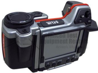
Εικόνα 3.8: Η συσκευή καταγραφής θερμότητας που χρησιμοποιήθηκε για την πραγματοποίηση των μετρήσεων της θερμοκρασίας στο εσωτερικό της MEK.
