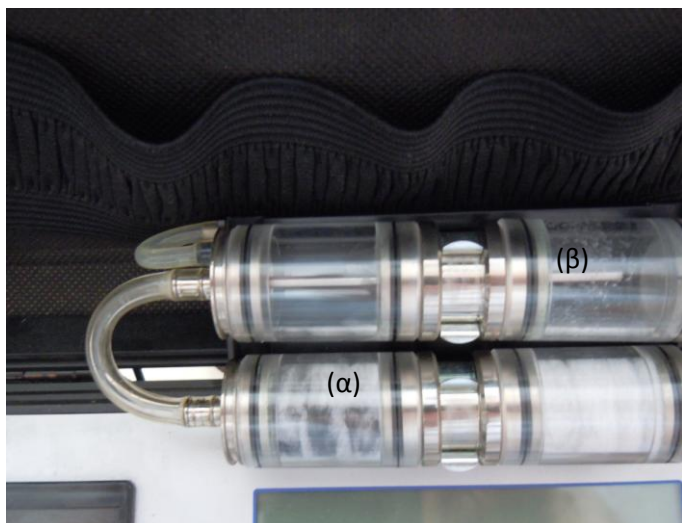
Εικόνα 4.4: Τα φίλτρα του αναλυτή αφού λήφθηκαν μετρήσεις στα καυσαέρια της εξόδου. Όπου: α) σωματίδια που κατακρατούνται από το φίλτρο του αναλυτή, β) παρουσία υγρασίας στο φίλτρο.
