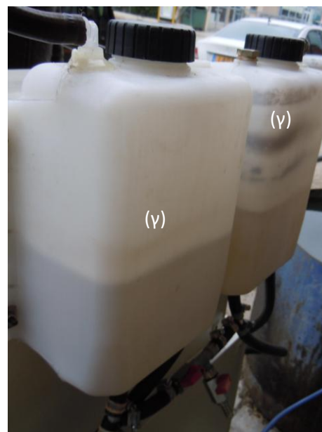
Εικόνα 3.5: Συσκευή ηλεκτρόλυσης που χρησιμοποιήθηκε για την παραγωγή H_2 . Όπου: α) κελιά ηλεκτρόλυσης με το νερό να διέρχεται μέσα από αυτά, β) μετατροπείας ηλεκτρικού ρεύματος και γ) δοχεία αποθήκευσης αποσταγμένου νερού που είναι τοποθετημένα στο πίσω μέρος της συσκευής.
