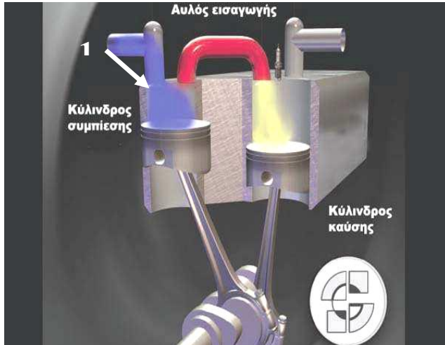
Εικόνα 2.6: Δημιουργία πυρανάφλεξης στη MEK και ακολούθως προανάφλεξη αν το μίγμα αναφλεγεί πριν την άφιξη του πιστονιού στο σημείο 1.
