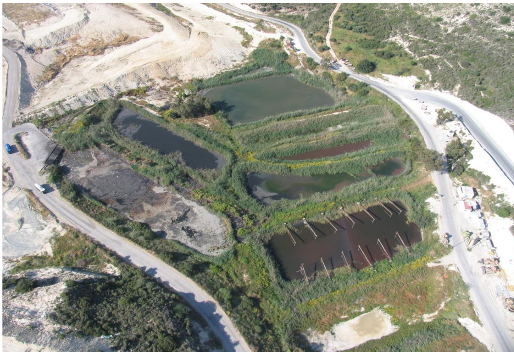
Εικόνα 1.8: Διαδοχικές λίμνες υπερχείλισης λυμάτων.
