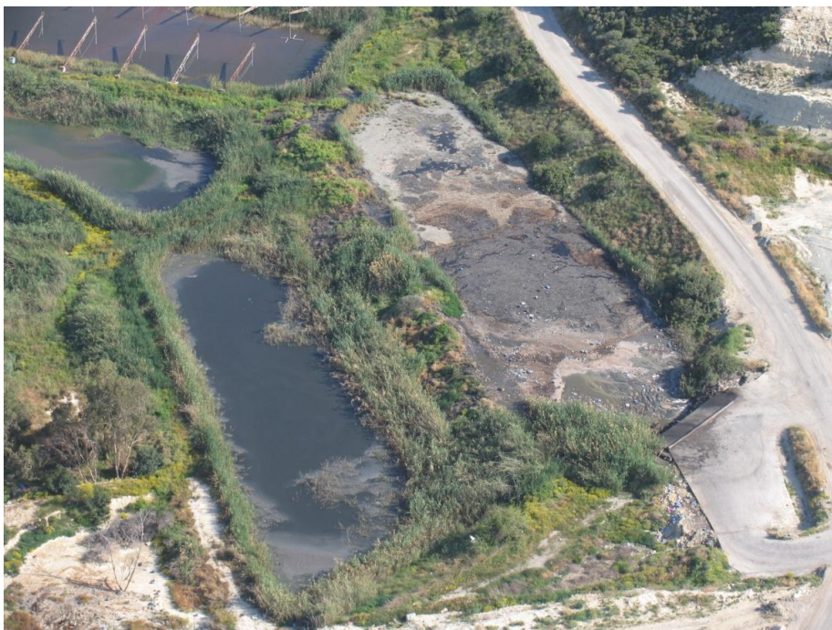
Εικόνα 6.1: Δεξιά: η πρώτη λίμνη με αποξηραμένη λάσπη, αριστερά: τα λύματα ρέουν κατευθείαν στις επόμενες λίμνες.
