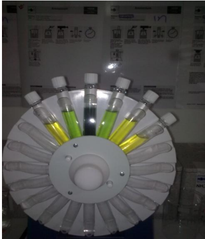
Εικόνα Π.36 & Εικόνα Π.37: Χημικές αναλύσεις για αμμωνιακά, νιτρικά και νιτρώδη ιόντα.
