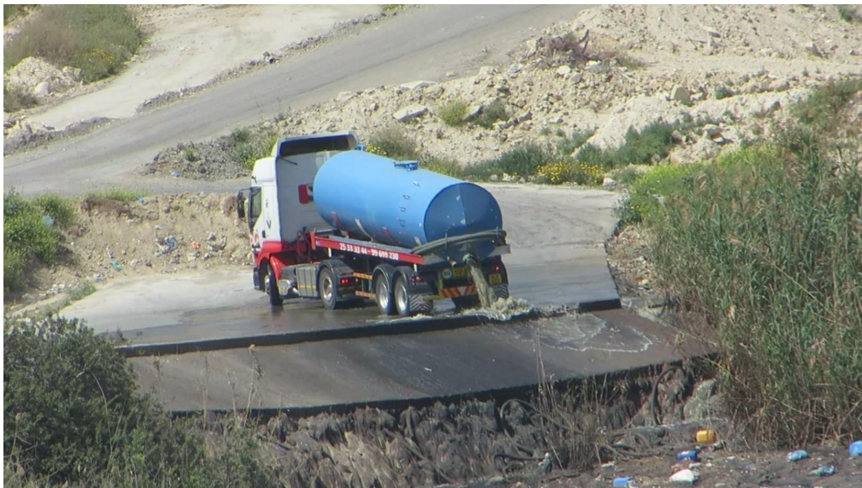
Εικόνα Π.43: Κανονική θέση απόρριψης βοθρολυμάτων.
