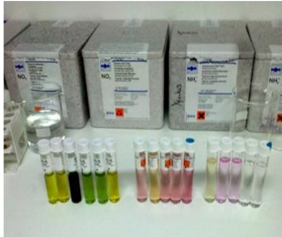
Εικόνα Π.36 & Εικόνα Π.37: Χημικές αναλύσεις για αμμωνιακά, νιτρικά και νιτρώδη ιόντα.
