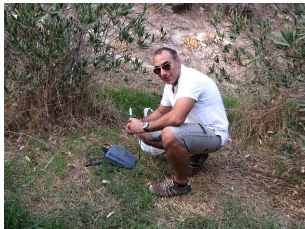
Εικόνα Π.19: Βαθμονόμηση πελάμετρου για λήψη μετρήσεων.
