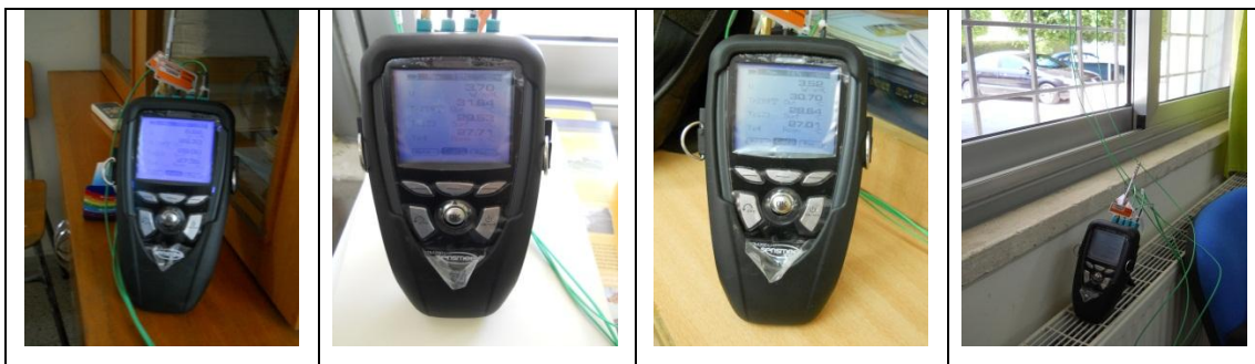
Εικόνα 24: Μετρήσεις συντελεστών θερμοπερατότητας σε δομικά στοιχεία του κτιρίου
