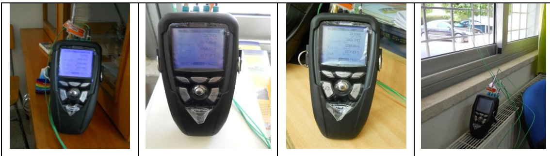
Εικόνα 13: Μετρήσεις συντελεστών θερμοπερατότητας με Uvalue-Calculator σε κατασκευαστικά στοιχεία κτιρίων
