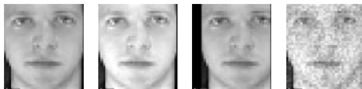
Εικόνα Γ2.1: (α) Αρχική εικόνα σε «φορμάτ προσώπου» (β) Υπό διαφορετικές συνθήκες φωτισμού (γ) Μετατοπισμένη (δ) Θορυβώδης
