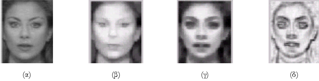
Εικόνα B1.1: (α) Αρχική Εικόνα (β) Εικόνα τοπικών μεγίστων (γ) Εικόνα τοπικών ελαχίστων (δ) Εικόνα διαφορών (τοπικά μέγιστα – τοπικά ελάχιστα)
