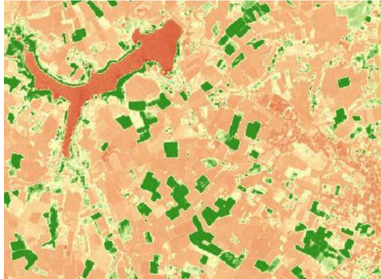
Εικόνα 8: Εικόνα RVI όπου το πράσινο αντιπροσωπεύει υψηλές τιμές του δείκτη που φανερώνουν πλούσια βλάστηση ενώ το κόκκινο χαμηλές έως μηδενικές τιμές που φανερώνουν παρουσία νερού, εδάφους, κατοικιών κ.α
