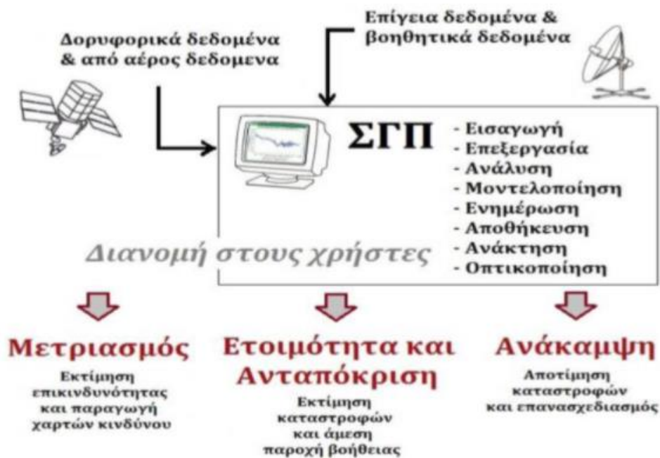
Διάγραμμα 13: Προσέγγιση της γενικής αρχής λειτουργίας της Τηλεπισκόπησης στη διαχείριση των καταστροφών (Γιορντάνοβα, 2015)
