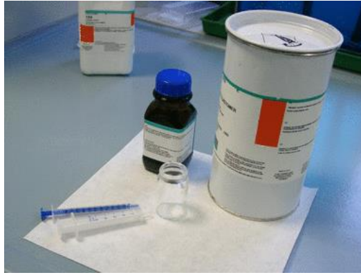
Διάγραμμα 13: Δεξιά το Sylgard 184 silicone elastomer και αριστερά ο παράγοντας ωρίμανσης.
