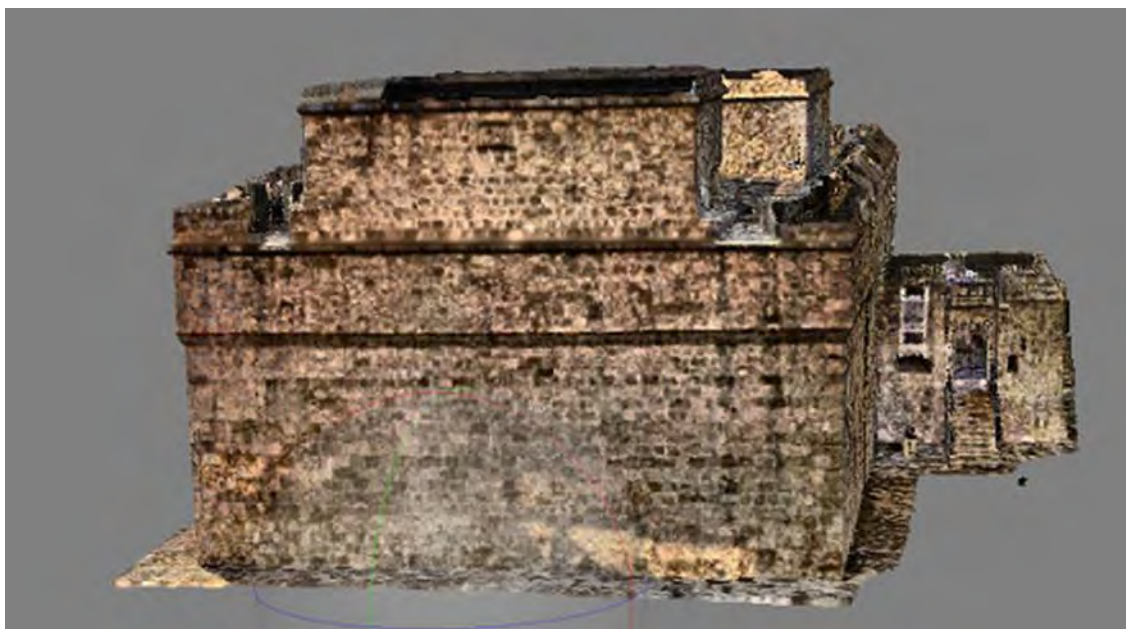
Διάγραμμα 15: Στην εικόνα παρουσιάζεται το Ψηφιακό Μοντέλο Επιφάνειας από όπως δημιουργήθηκε στο λογισμικό SCENE.
