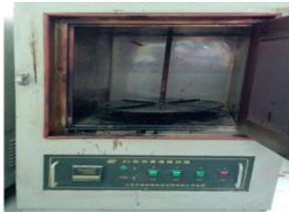
Εικόνα 12 : φούρνος που χρησιμοποιείται για την διαδικασία TFOT (Zeng et al. , 2015)
