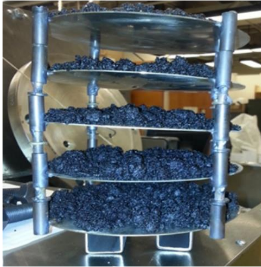
Εικόνα 6: Βραχυχρόνια γήρανση μίγματος σε φούρνο (Castorena et al., 2015)
