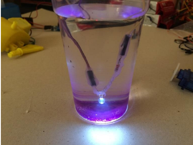
Εικόνα 10: Επιτυχής δοκιμή στεγανοποίησης με ζεστή κόλλα.
