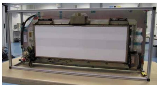
Διάγραμμα 8 Μηχανισμός βαθμονόμησης και κλείστρου MSI που δείχνει τον διαχύτη. (Sener, Ισπανία και CSL, Βέλγιο)
