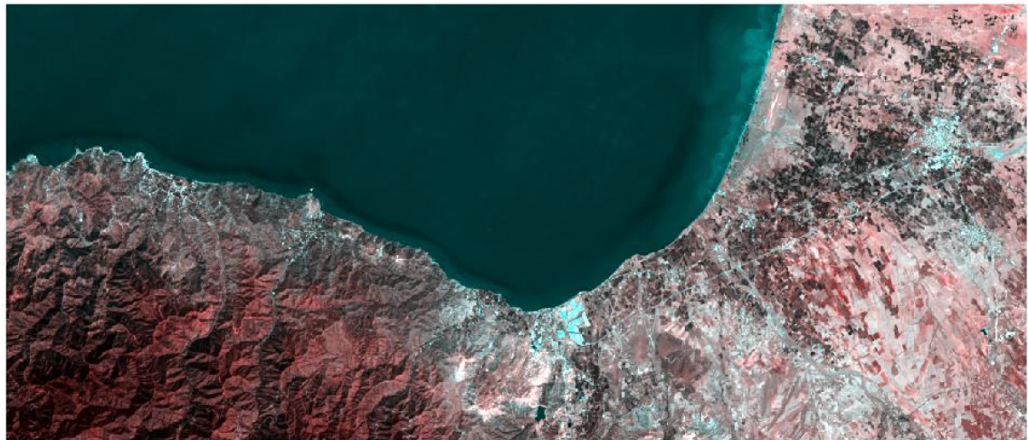
Διάγραμμα 30: Δεδομένα Sentinel-2, Ψευδοχρωματικό Σύνθετο 6-1-1 → Οπτικός εντοπισμός κατηγοριών εδάφους και υδάτινων επιφανειών
