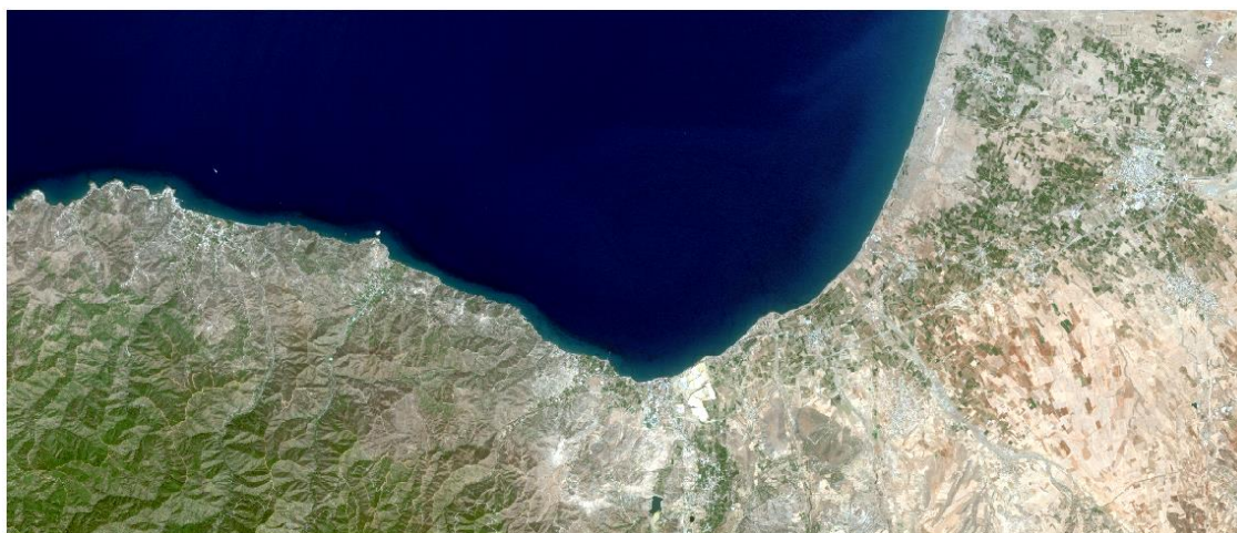
Διάγραμμα 25: Τελικό πολυφασματικό προϊόν 6 καναλιών Sentinel-2, Ανάλυση 30 m, Έγχρωμο σύνθετο: 3-2-1
