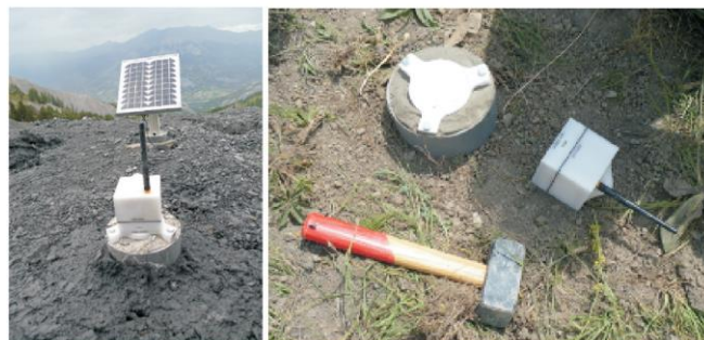
Διάγραμμα 1: Ασύρματος δέκτης GPS χαμηλού κόστους Geocube
