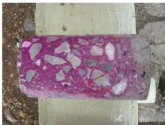
Διάγραμμα 39: Έλεγχος βάθους ενανθράκωσης (Αντωνιάδης, Γκλαβίνας & Χατζόγλου 2013)
