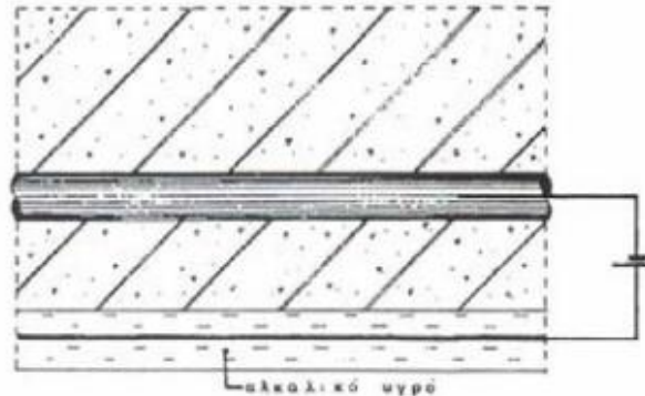
Διάγραμμα 57: Επαναλκοποίηση του σκυροδέματος (Δημάδη & Κατσεινίου 2007)
