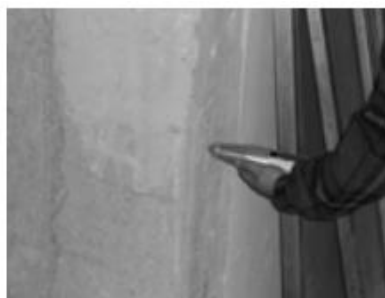
Διάγραμμα 30: Μέθοδος κρουσιμέτρησης (Σπυράκος 2004)
