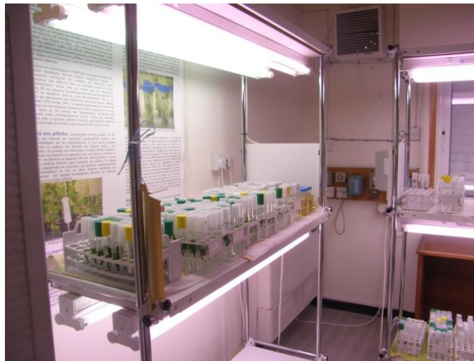
Εικόνα 2. 8. Θάλαμος σταθεράς θερμοκρασίας και φωτισμού για επώαση φυτών που αναπτύσσονται in vitro
